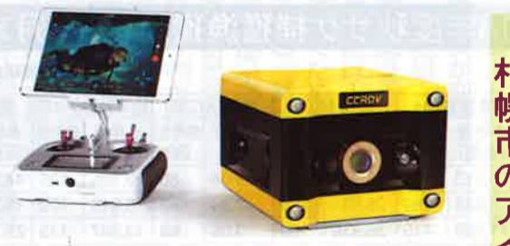
建設コンサルタントなどの株式会社アイ・ティ・エス(札幌市、下川俊克社長、電話011-743-1707)は産業用の水中ドローン「CCROV」を導入。垂直に沈み、前後左右に水平移動が可能なのが特長。旋回もできる。橋桁や橋台における水中の点検調査に使える
